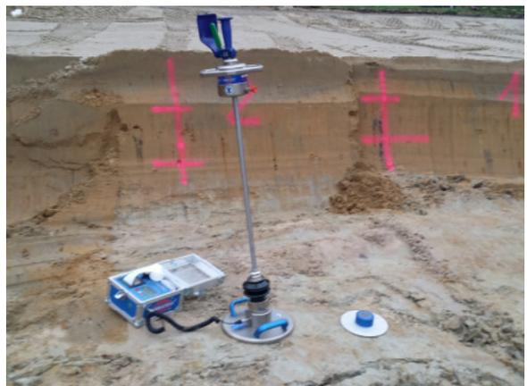
Plattendruckversuch im Testfeld
